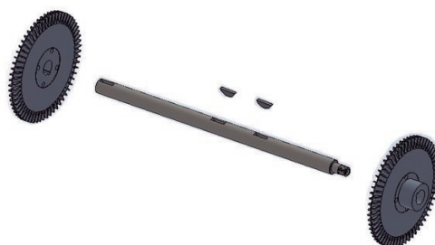
2. La flecha, los impulsores y las cuñas de los impulsores, para bombas de dos pasos.
