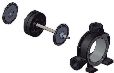
1. La bomba, con la flecha, impulsores y los anillos espaciadores removidos. El impulsor del lado del motor ha sido removido de la flecha.
