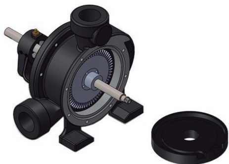
F. La bomba con los anillos de desgaste quitados. La forma del conducto exterior del agua y el lugar de los registros de la descarga se pueden ver.
