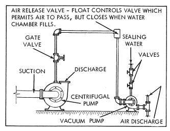
FIGURE 7. VACUUM PUMP PRIMING
